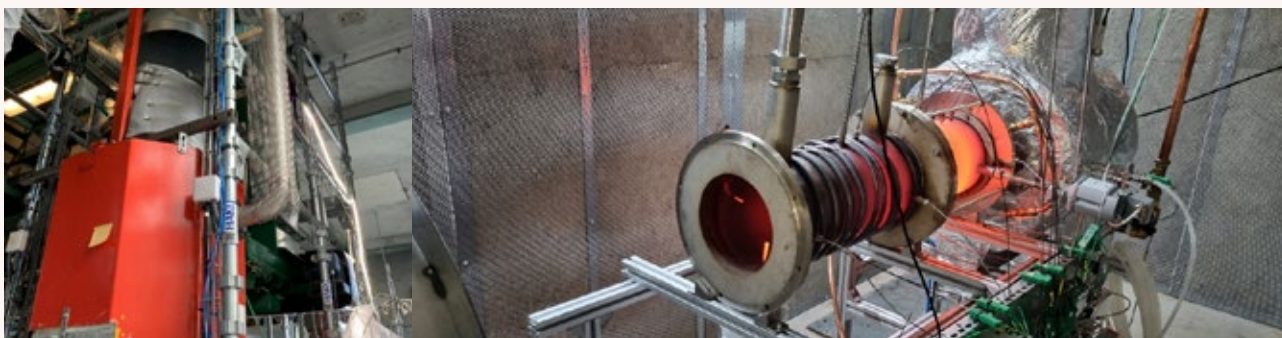
Figur 11: Scarletrighens där det ingår en förgasare (vänster) gasrening och en brännkammarrigg (höger) där förbränningsprov med förgasad biomassa, gasol kan göras. Righen nu kompletteras med vätgas och metan för fullständiga prov av prestandan in om BioFlexGen och Biokraft 2023!. Omfattande förgasningsprov ska göras inom EUCANwin!
