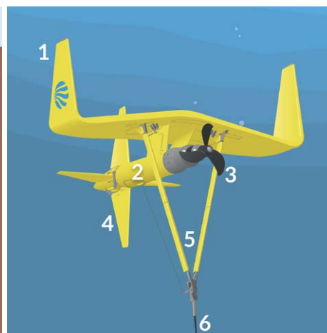
Bild 4. Minestos marina kraftverk Deep Green består av en ving (1), som bär upp ett maskinhus (nacelle) (2). Framtill i maskinhuset sitter turbinen (3) som är kopplad till en generator. I den bakre delen av maskinhuset finns kraftverkets styr- och kontrollsystem. Med hjälp av roder (4) styrs kraftverket automatiskt i en förutbestämd bana. Stagen (5) är kopplade till en förankringslina (6) som kopplar kraftverket till en förtöjningspunkt fäst i ett fundament på havsbotten. Förankringslinan rymmer elkablar såväl som kablar för kommunikation. Källa: Minesto
